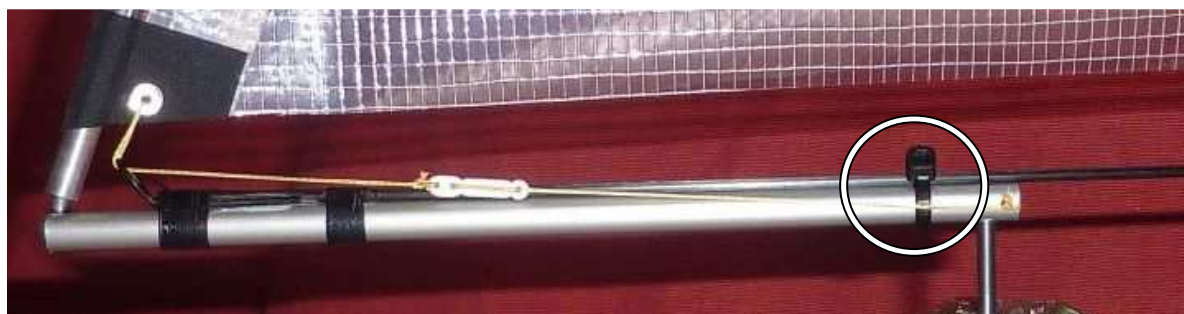
Kabelbinder in „Schwachwind“-Position – der Großbaum gibt jetzt weniger nach
